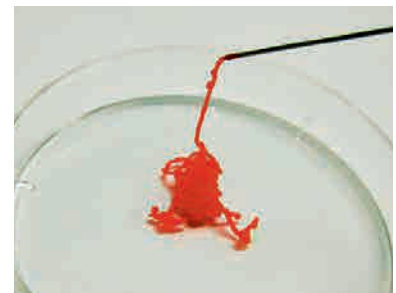
高濃度に分散させると糊状になり、 注射針で扱うことができます。 (見やすくするためにエオシンで着色しています。)
